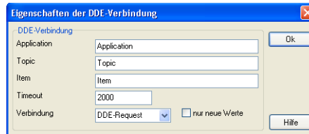
Abbildung 3-5. Adressierung des DDE-Kanals im DDE-Eingangsblock
